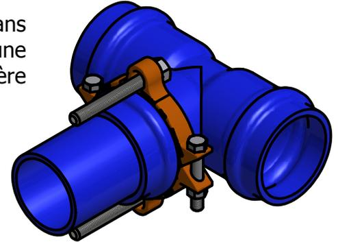
2. Utiliser les tiges de retenu comme guide pour positionner les demi-lunes 300C sur le tuyau. Placer les boulons et noix hexagonales dans les oreilles du collet en s'assurant que les filets des tiges filetées soient apparents.
